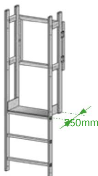
Podest 250 mm mit montiertem Schutzgitter 580 mm
