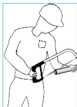
12 - Justieren Sie den letzten Abschnitt, indem Sie den gestauchten Überschuss sägen.
