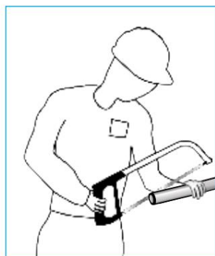
11 - Justieren Sie den letzten Abschnitt, indem Sie den gehämmerten Überschuss sägen.
