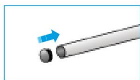
12 - Setzen Sie die Ecken ein Winkel von Handläufen und Knieleisten.
