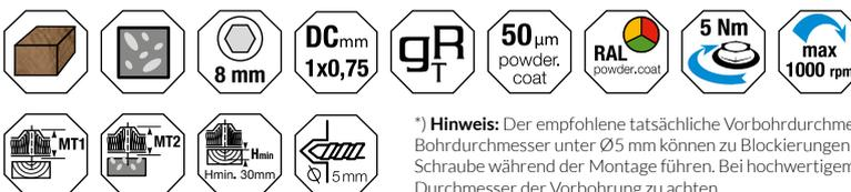
\*) Hinweis: Der empfohlene tatsächliche Vorbohrdurchmesser beträgt Ø5 mm. Bohrdurchmesser unter Ø5 mm können zu Blockierungen oder Beschädigungen der Schraube während der Montage führen. Bei hochwertigem Beton ist besonders auf den Durchmesser der Vorbohrung zu achten.
